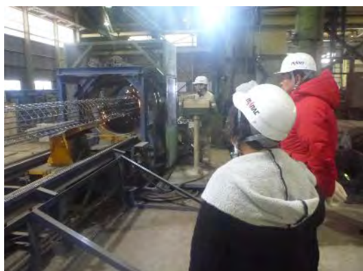
鉄筋コンクリート杭の 鉄筋自動溶接作業の見学
