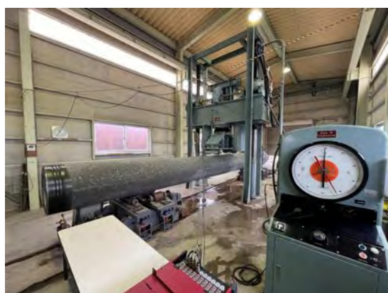
鉄筋コンクリート杭 コンクリート強度試験
