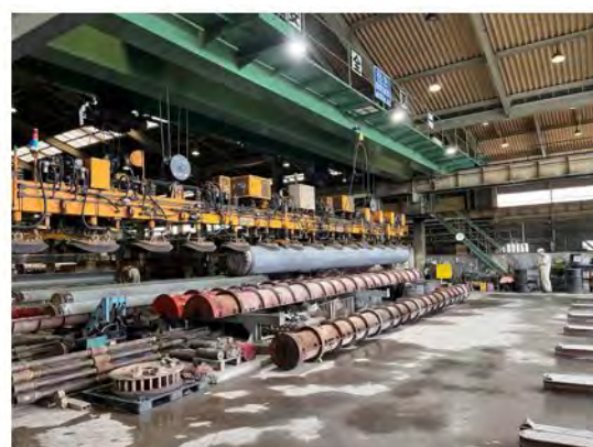
鉄筋コンクリート杭の完成時 便利な吊り上げ移動作業の機械
