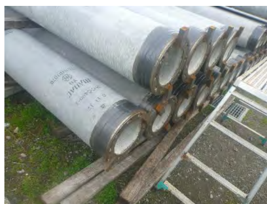
遠心力を利用した プレストレストコンクリートパイル
