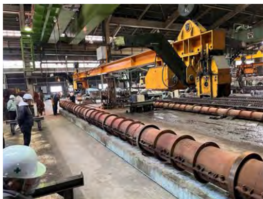
鉄筋コンクリート杭の型枠設置後 遠心力で回転させ中空になります。
